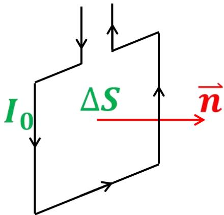
载流平面试验线圈
