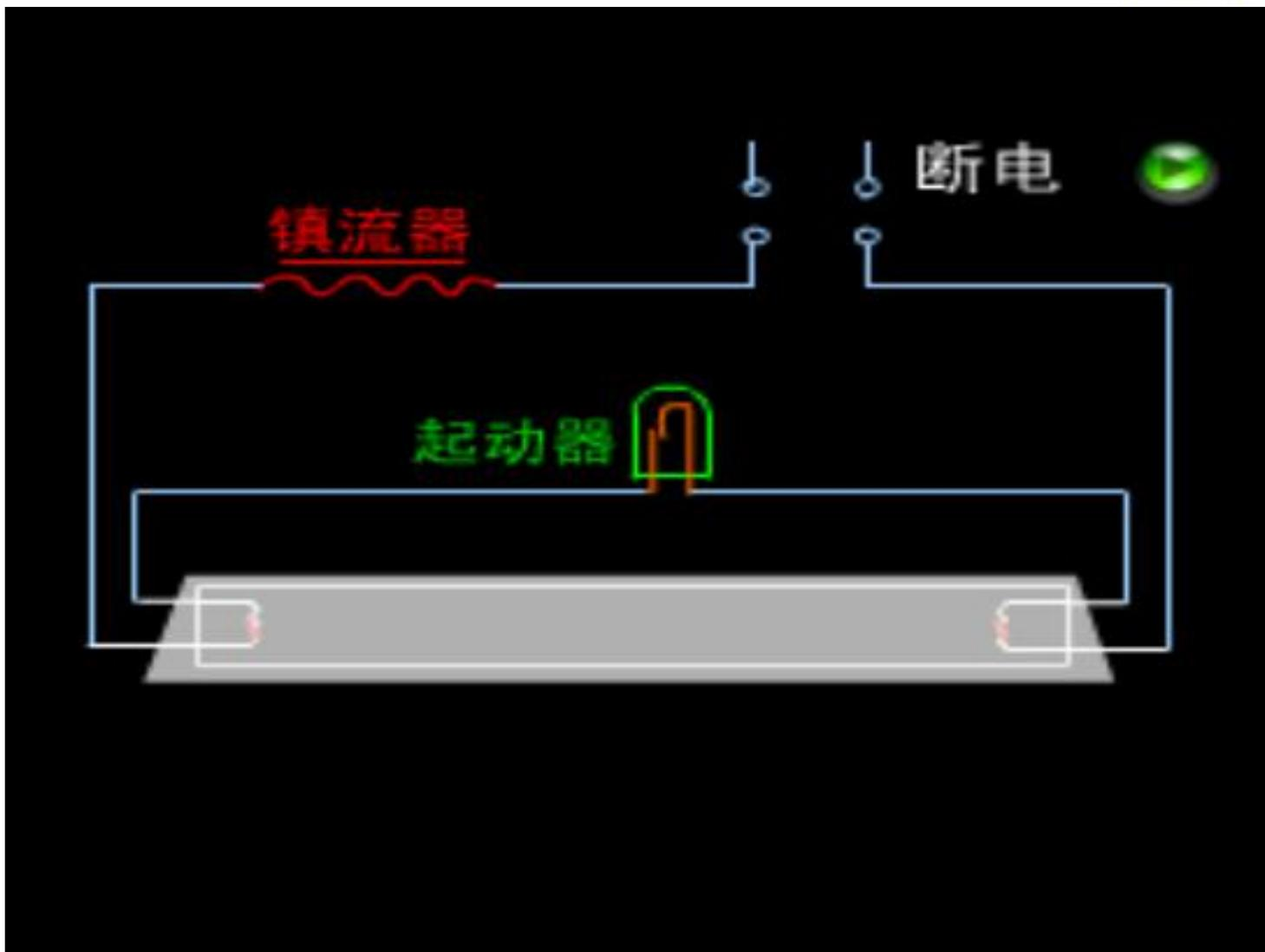
作用：**限流**（启辉器闭合）和产生**瞬间高压**（启辉器开路）
