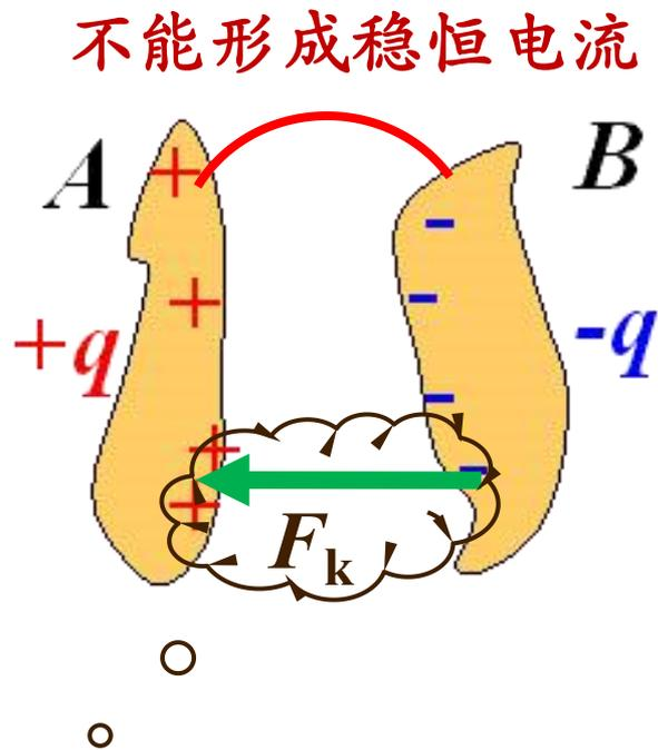
**电源**—提供非静电力而把其它形式的能量转换成电能的装置，或称电泵。
