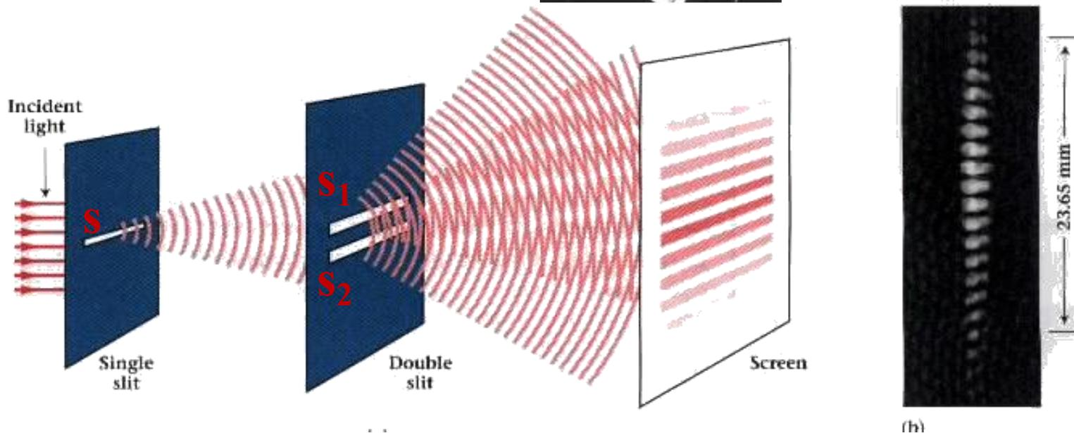
由双缝 $S_1$ 和 $S_2$ 发出的两相干光在屏幕上各点叠加。
