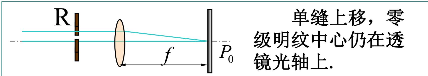
光栅所有狭缝的单缝衍射图案重叠！
