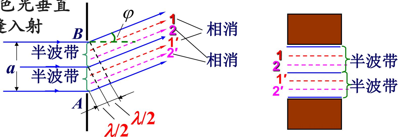
两个半波带发的光, 在  $P$  点干涉相消形成暗纹。
