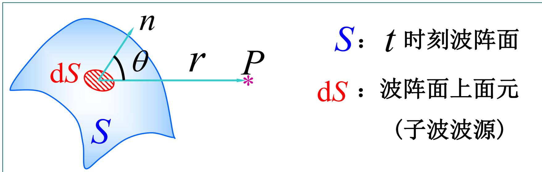
**惠更斯—菲涅耳原理:** 从同一波阵面上各点发出的子波, 在传播过程中相遇时, 也能相互叠加而产生干涉现象, 空间各点波的强度, 由各子波在该点的相干叠加所决定.
