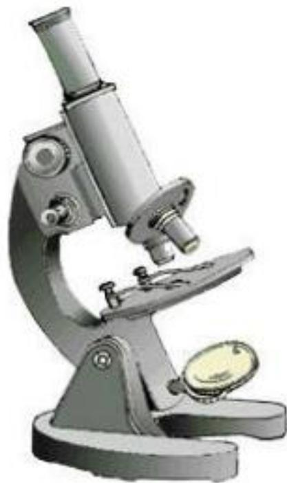
**瑞利判据：**对于任何一个光学仪器，如果一个物点衍射图样的艾里斑中央最亮处恰好与另一个物点衍射图样的第一个最暗处相重合，则认为这两个物点恰好可以被光学仪器所分辨。
