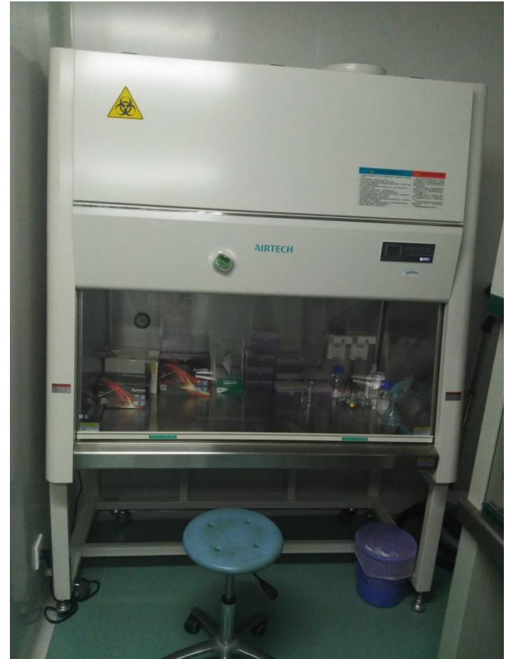
Biosafety cabinet 生物安全柜
