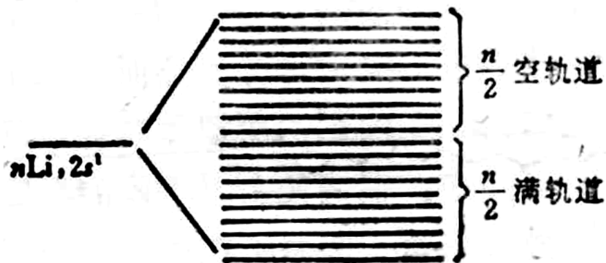
图 4-45 Li 金属晶格的分子轨道图
