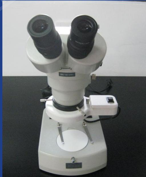
1. 双目镜筒中的左右两光束不是平行的，而是具有一定的夹角——体视角（一般为 $12^{\circ} \sim 15^{\circ}$ ），因此成像具有三维立体感；
