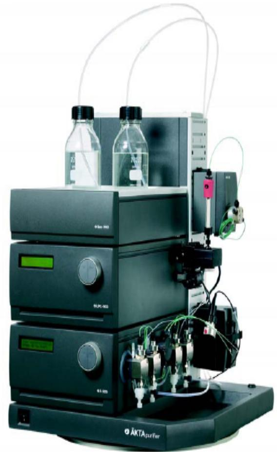
层析设备是逐渐发展的，以往做层析设备需要用到多种设备，如泵、检测器、记录仪等，AKTApurifier将各种设备整合到了一起，通过软件来控制层析过程。
