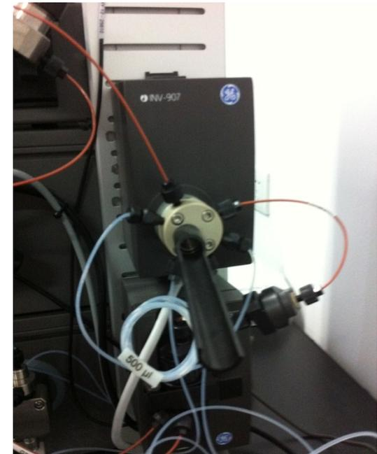
上样阀是个7通阀，阀芯上的通路决定了液体的流向，有三种状态：load, inject, waste
